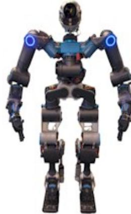
leggerezza delle gambe prive di motori lungo la parte bassa; versatilità e destrezza nella manipolazione. Il busto è in grado di ruotare di 180 gradi, facilitando così la manipolazione degli oggetti in ogni direzione intorno al robot,
